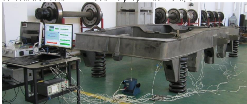
Fig. 2.2. Montaj pentru analiza modală experimentală a ramei de boghiu LE-MA
