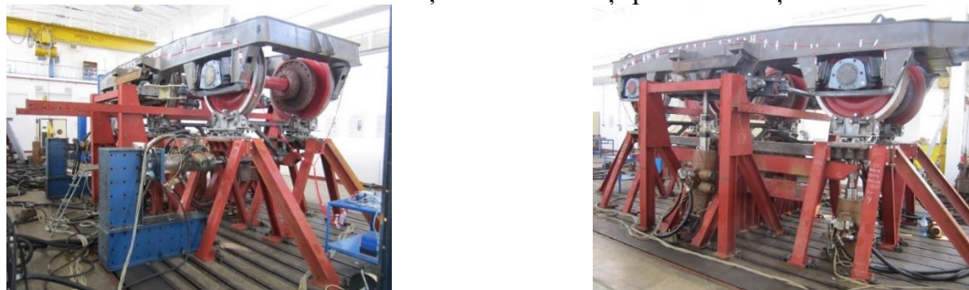
Fig. 2.6. Amplasarea boghiului LE-MA pentru încercările la solicitări statice și oboseală
